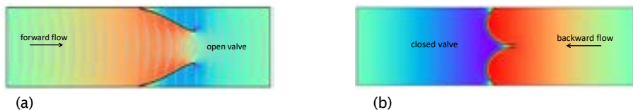
Figure 1. (a) Le champ de pression (rouge: pression maximale, bleu: pression minimale) et le champ de vitesse en cas de l'ouverture de la valve, (b) Le champ de pression en cas de sa fermeture.
